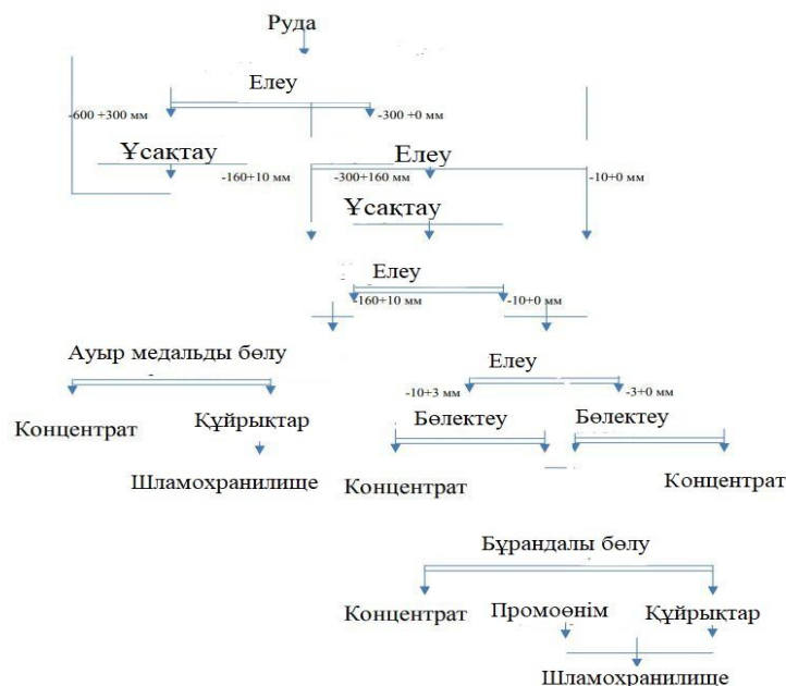
1 сурет – Дөң КБК гравитациялық байытудың техникалық схемасы
